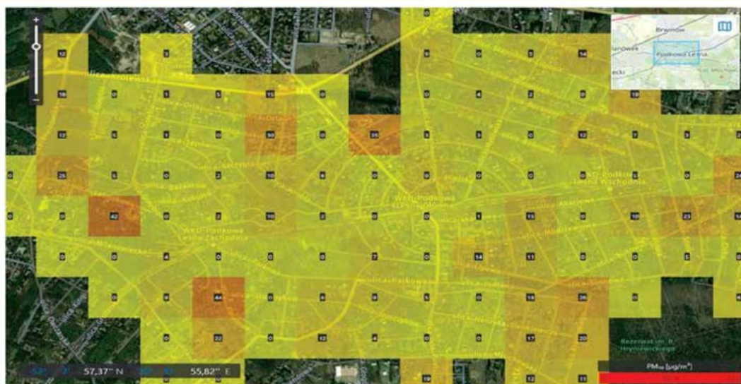
Rysunek 38. – Pomiar stężenia pyłów PM10 – pomiar z drona dnia 2.03.2022
