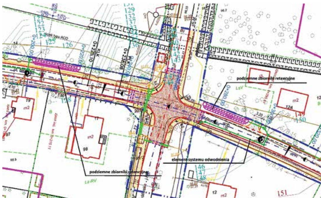
Rys 5. Fragment planu zagospodarowania z projektu wykonawczego przebudowy ulicy Helenowskiej z lokalizacją podziemnych zbiorników retencyjnych
